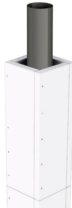
Geliefert werden die SILCA® PRO LC90 Zuschnitte in Verpackungseinheiten von jeweils 4 Platten und einer Länge von 1250 mm. Die Platten werden gemäß beiliegender Montageanleitung verklebt und mit Klammern oder Schrauben zusammengefügt. Hierbei ist sowohl eine versetzte Variante aber auch ein einfaches stumpfes Übereinandersetzen der Module möglich. Der weitere Aufbau erfolgt ohne weitere Steckverbindungen.
