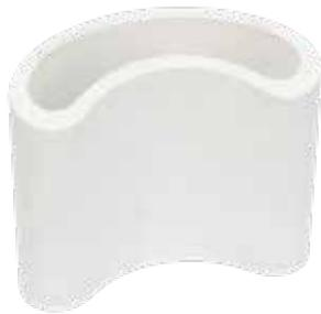
**CALCAST®** ist ein Hochtemperatur-Dämmstoff aus Calciumsilicat mit Raumgewichten von 860 bis 1.040 kg/m<sup>3</sup>. Die Anwendungsgrenztemperatur beträgt 1.000 °C. Der Werkstoff wird von flüssigem NE-Metallen nicht benetzt und ist deshalb ein idealer Werkstoff für Gießanlagen in direktem Kontakt mit flüssigem Metall. **CALCAST®** isoliert und wird zur Verteilung des flüssigen Metalls verwendet.
