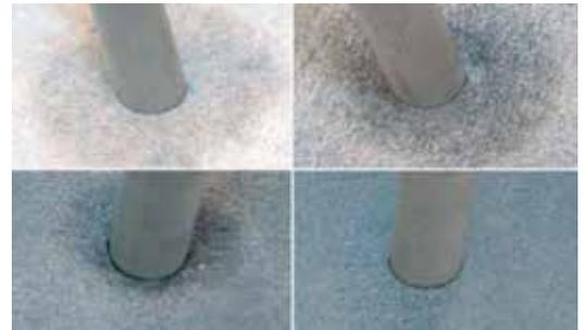
Ölspuren auf der Oberfläche nach 144 h bei Raumtemperatur
