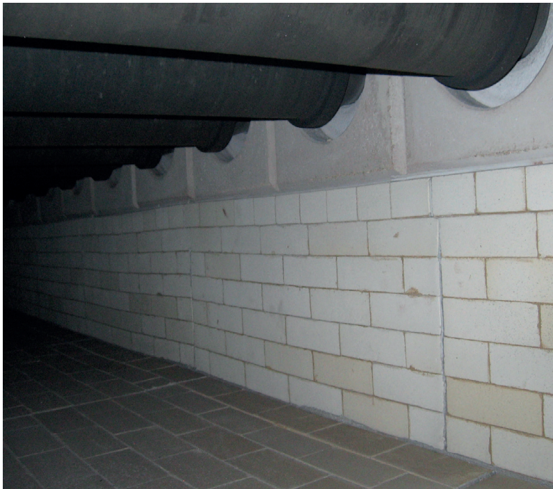
Rollenherdofen 1050 °C mit SILCAREF
